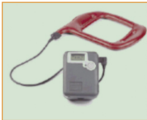
Fig. 1 A sinistra il generatore CEMP I-ONE. A destra la forma d'onda del campo magnetico, con un picco d'intensità di 1,5 mT (in alto); la forma d'onda del campo elettrico indotto in una sonda standard di 50 giri (0,5 cm \emptyset ) di filo di rame (0,2 mm \emptyset ), con valore di picco 3 mV/cm (sotto)
